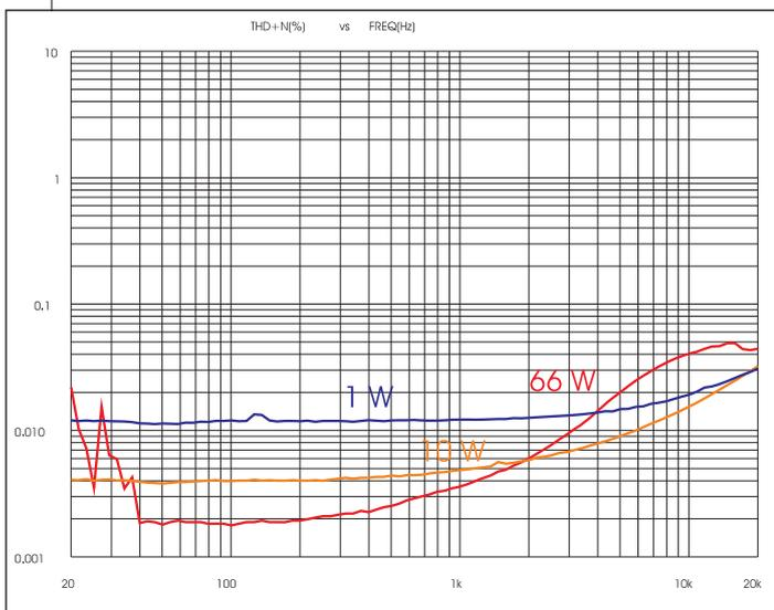
Andamenti frequenza/distorsione per potenze di uscita 1, 10 ed 80 watt su 8 ohm. Comportamento nella "buona norma", con residuo in salita verso le alte ma con moderata pendenza, soprattutto a potenze basse e medie, e con valore massimo mai superiore allo 0.05%.
