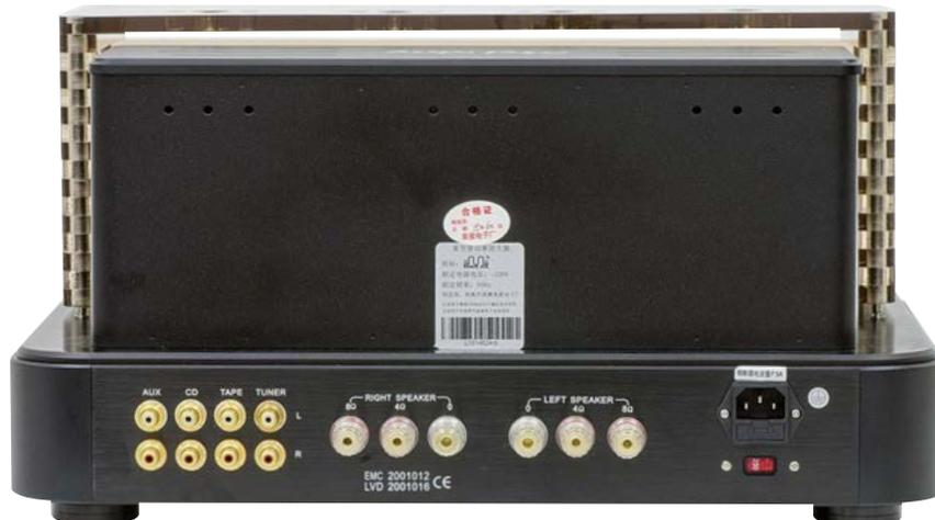
Un pannello posteriore alquanto classico, con 4 coppie di pin RCA dorati per sorgenti di livello linea e morsetti del tipo WBT sdoppiati per carichi nominali di 8 e 4 ohm.
